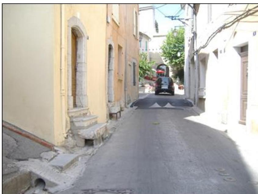
*Figure 4 : Exemple d'une voirie possédant un réseau pluvial limité mais dont la circulation éventuelle de ruissellements sur la voirie n'entraîne pas automatiquement l'inondation des bâtis*
